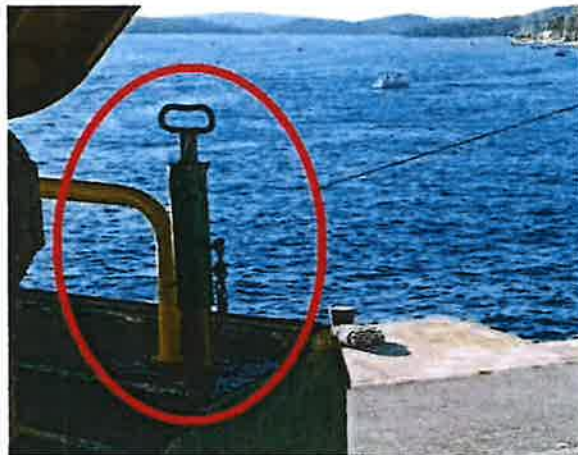
Slika 10. Prikaz poluge (klina) za osiguranje rampe u gornjem položaju (dok je poluga (klin) u ovom položaju rampa nije osigurana)
