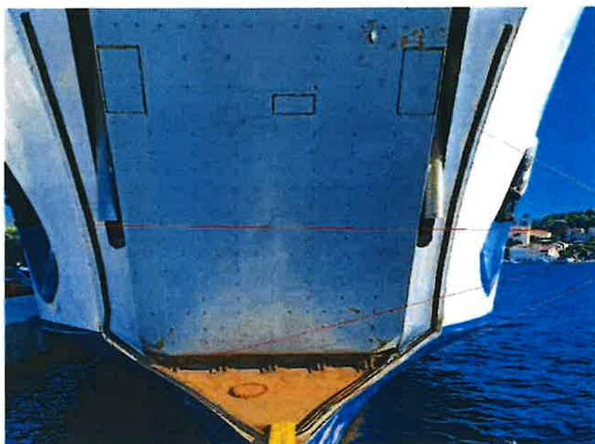
Slika 3. Prikaz brtve pramčanih vrata („vizira“) koju je posada imala namjeru pregledati
