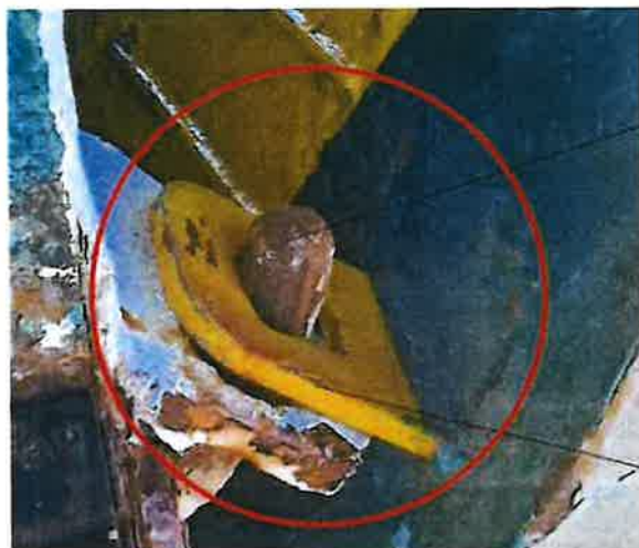
Slika 11. Prikaz bolcena uglavljenog u ušku na desnoj strani pramčane rampe
